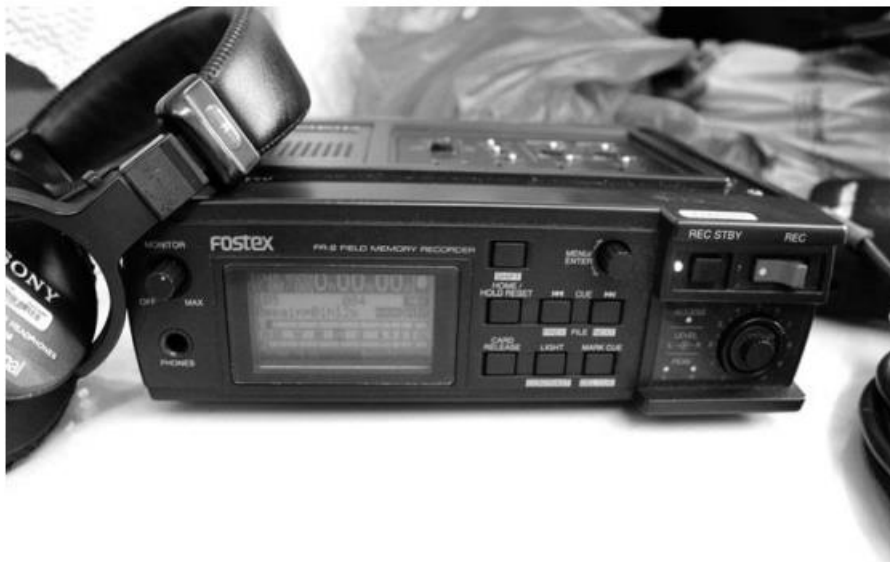
2.11. rasm. The Fostex FR-2 ovoz yozish qurilmasi
