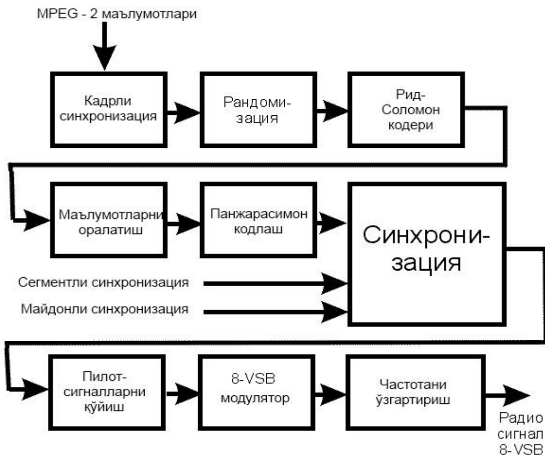
5.23-расм. ATSC тизимининг узатувчи қисми тузилиши.
