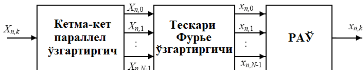
2.26-расм. OFDM сигналини ҳосил қилиш принципи.
