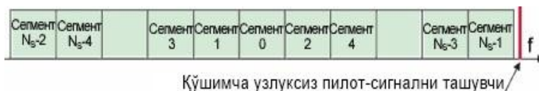
5.28-расм. Узатилаётган радиосигнал спектри ( N_s -сегментлар миқдори)
