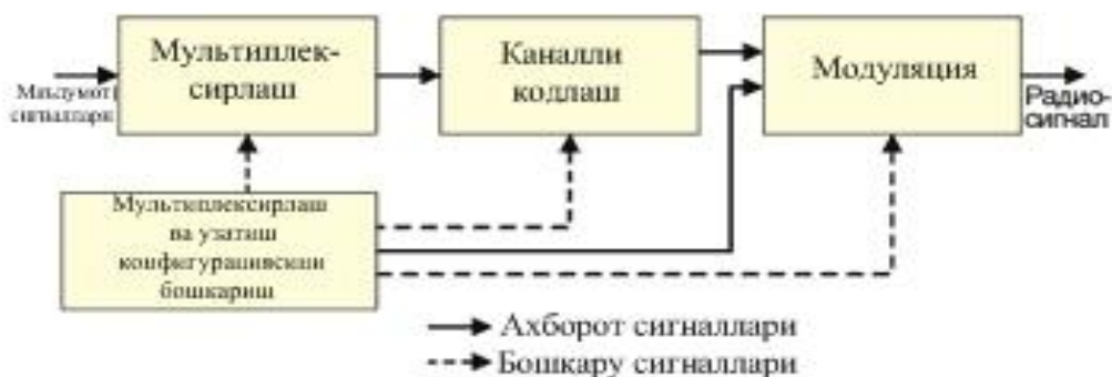
5.26 – расм. ISDB – Т тизимнинг узатиш чизмаси
